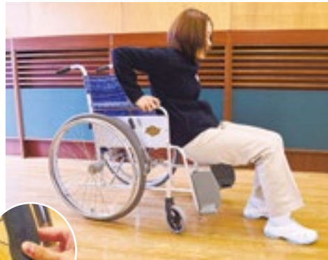
タイヤの空気圧が足りないと車いすのブレーキが効かずに転倒することが...
